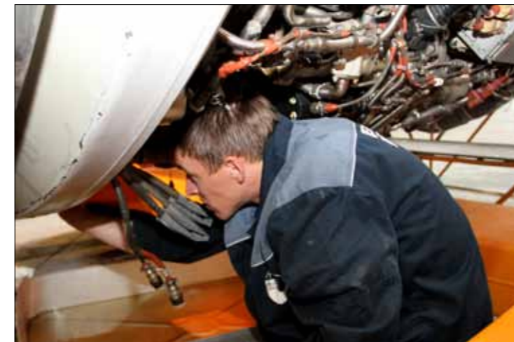
Монтаж электропроводки реверсивного устройства специалистами ОАО «Пермский моторный завод»
