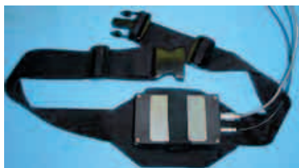
Рис. 14. Оценочный набор модуля GyroDRM, встроенный в пояс, в водозащитном исполнении
