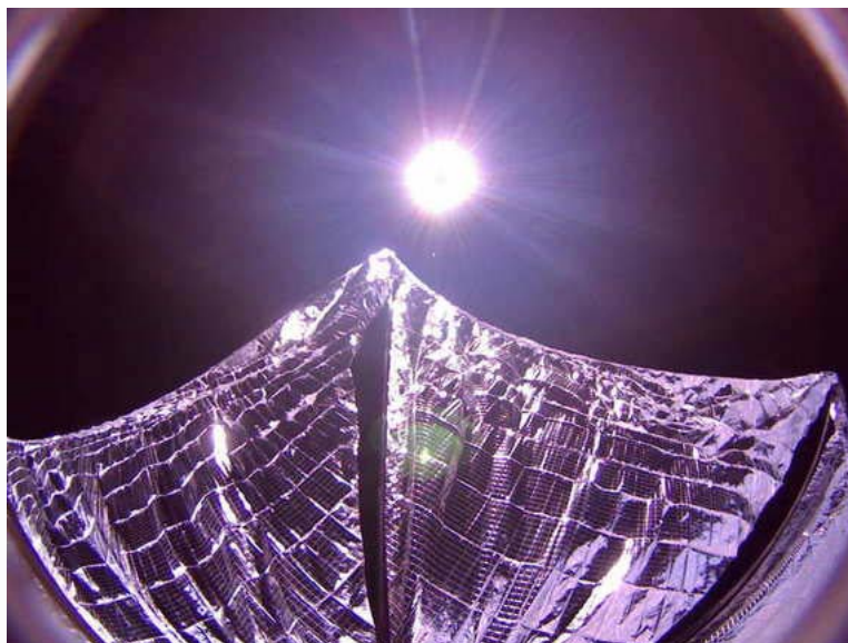
Изображение развёрнутого солнечного паруса на околоземной орбите, полученное 9 июня с космического аппарата LightSail
