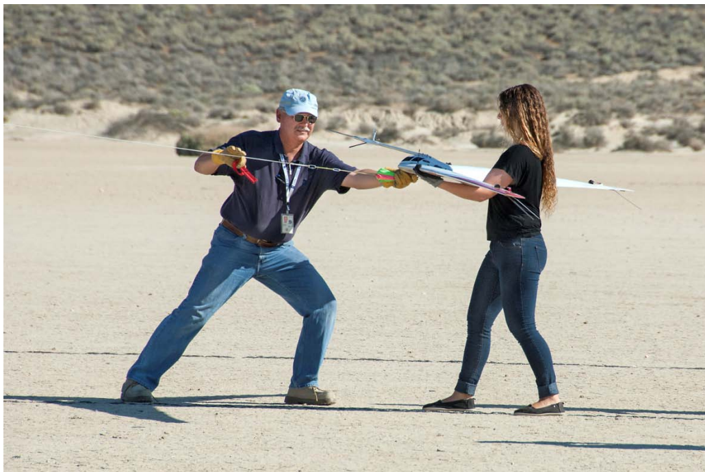
Эл Бауэрс (слева) в процессе испытаний крепит пружинящий шнур к планеру Prandtl-d – предшественнику планера Prandtl-m, – а ассистент готовится отпустить аппарат в полёт.
