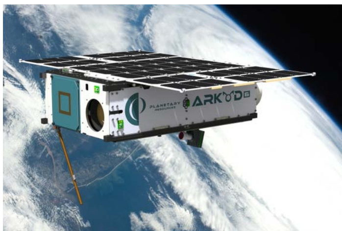
Спутник Arkyd 6 будет запущен во второй половине 2015 года с целью тестирования систем управления, энергоснабжения, связи и бортовой электроники в интересах разработки ресурсов астероидов.
