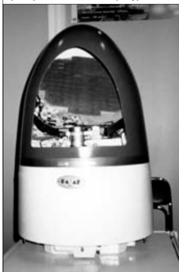
Головка самонаведения АРГС-35 для крылатых ракет
