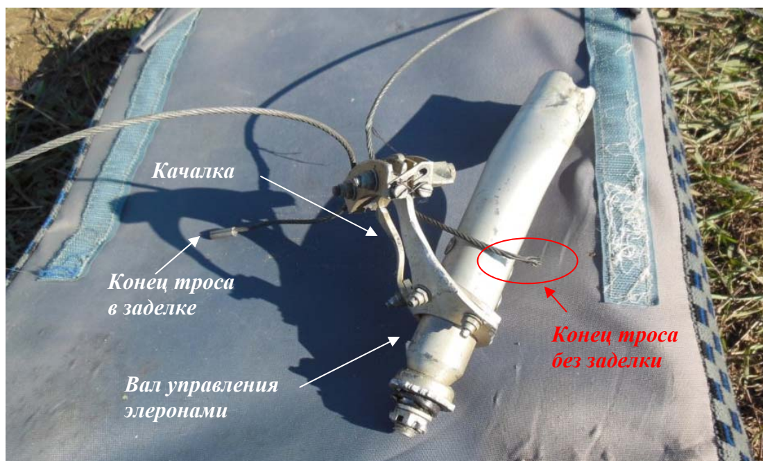
Рис.5. Отсутствие заделки в наконечник троса управления левым элероном
