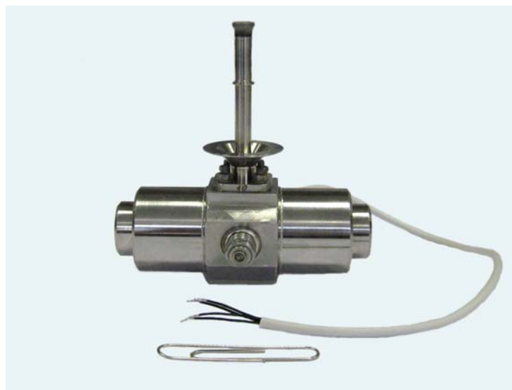
Рис. 13 Макетный образец ГКМ с номинальной холодопроизводительностью 0,2 Вт.
